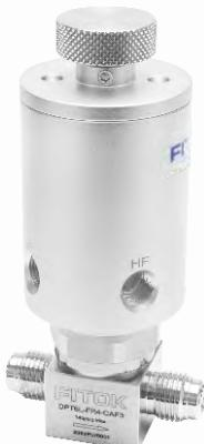
两段式气动隔膜阀 DPT 系列定位于高纯和超高纯应用，可在低流量和高流量间快速切换，实现设备的“软启动”，用来防止介质急骤流入工艺设备腔体而造成压力骤然上升以及微粒飞扬污染腔体。
